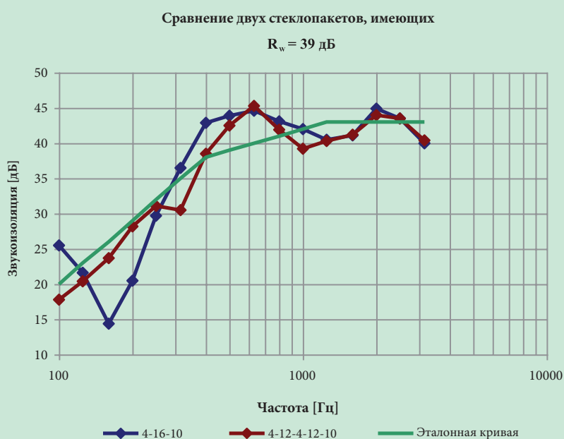
Рисунок 5: Сравнение звукоизоляции двух стеклопакетов
